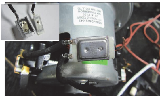
(a)保護裝置(繞組 LN 相串接溫控開關)
