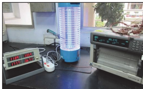
(a)捕蚊燈負載側電擊網短路情形
