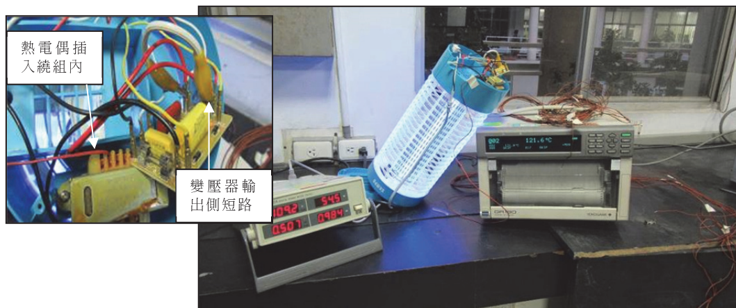
(a)變壓器二側短路，熱電偶監測繞組溫升情形(此時已上升至 121 °C)
