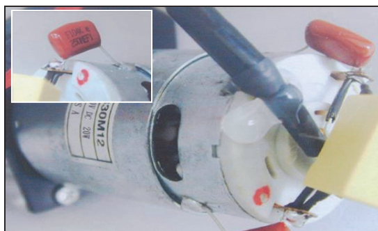
(b)保護阻抗(繞組 LN 相並接 Y 電容)
