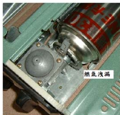
圖 2 容器誤裝造成燃氣洩漏
