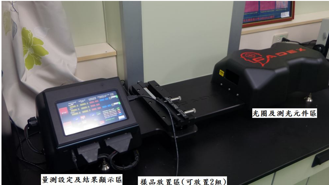
圖 2 鏡片擴散光量測設備外觀
