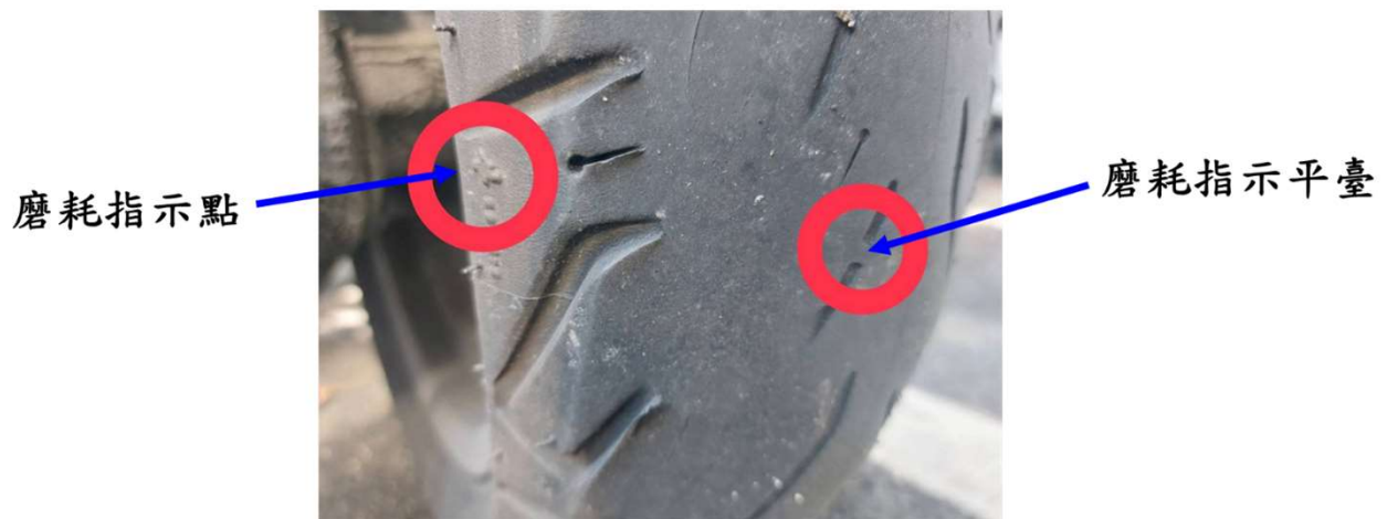
圖3 輪胎溝紋已磨耗至指示平臺 (須更換新胎)
