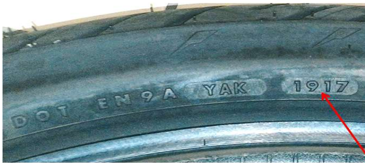
圖1 製造日期代碼之標示圖例
