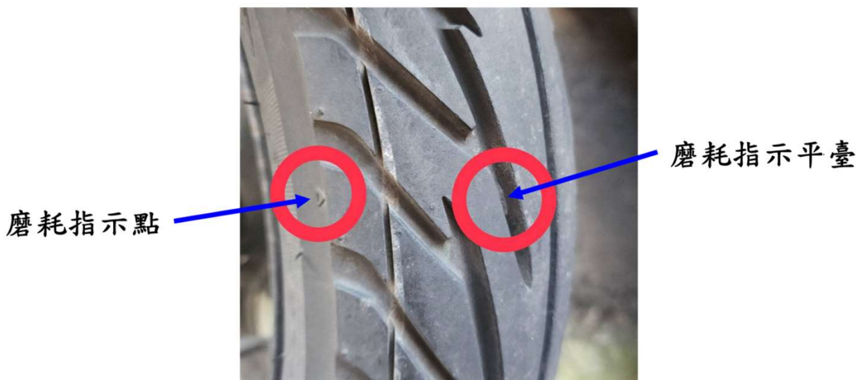
圖2 輪胎磨耗指示點及磨耗指示平臺
