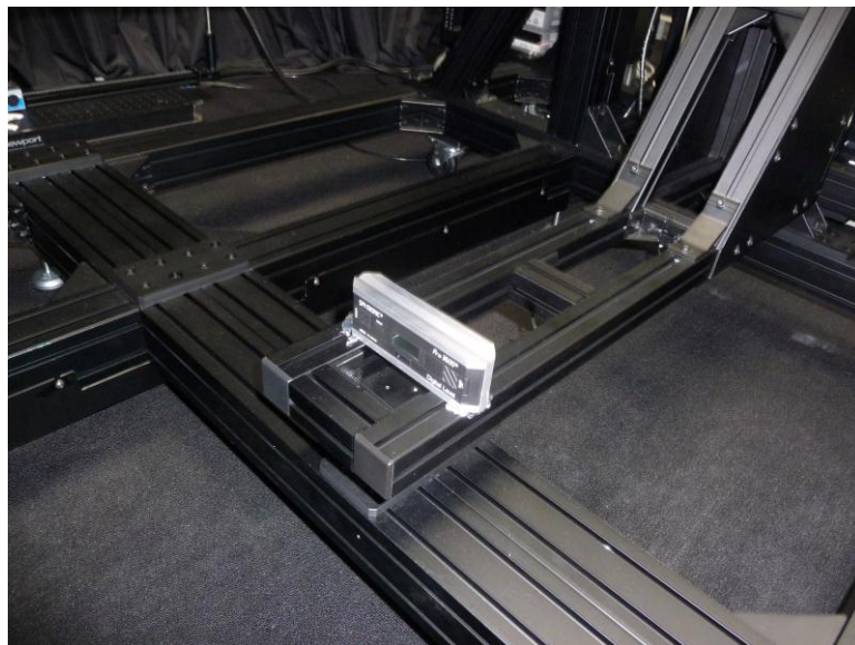
圖 3 角度驗證實驗架設圖
