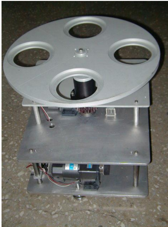
圖 32 氣瓶質量自動量測裝置
