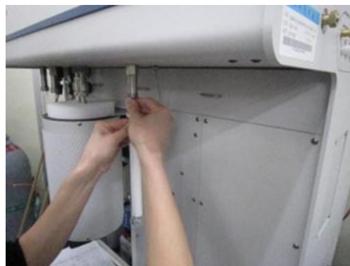
圖 1-12 b BET量測系統架設與組裝
